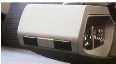
N-700系グリーン車・モバイル用コンセント
