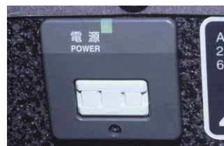
N700系普通車・モバイル用コンセント
