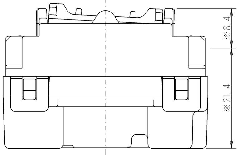
※部は、J・WIDE 取付枠施工時壁面から寸法を示します。
