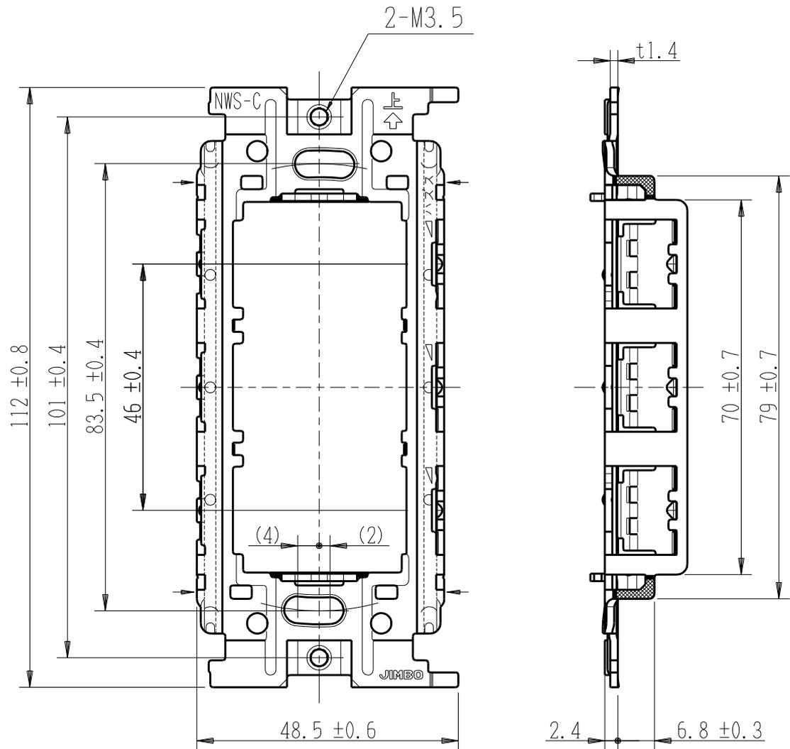
金属ワンタッチ取付枠と「塗代カバー」や「はさみ金具」が干渉する場合は、取付枠の四隅をニッパで切り取ってください。
