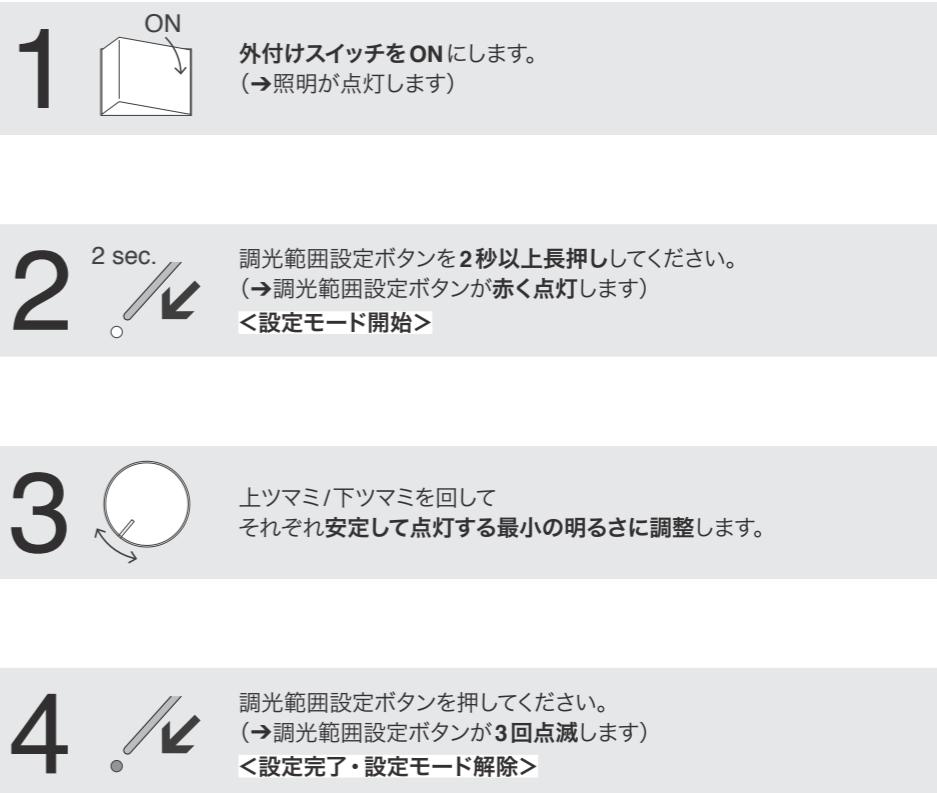
\*設定モードに入った状態のまま5分間操作しない場合は、自動的に設定モードを解除します。(調光範囲は設定モード開始前の状態に戻ります)
