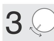
調光ツマミを回して安定して点灯する最小の明るさに調整します。
