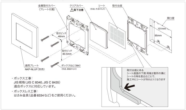
・ボックスねじは、必要以上に締め付けないでください。 (適正締付トルク:0.4N·m(4.1kgf·cm)以下) 取付台座の変形により器具の沈み込みが生じて外観不良の原因になります。 ・器具の取付面は、できるだけ平らに仕上げてください。 プレートが取付面の反りに追従しきれず、隙間が生じる原因になります。
