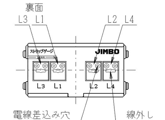
■適用電線 :  $\phi 0.4 \sim \phi 0.65$ 銅単線専用
