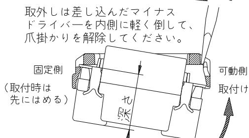
器具深さ（ツメからの深さ）が27mm以下の器具が適合します。
