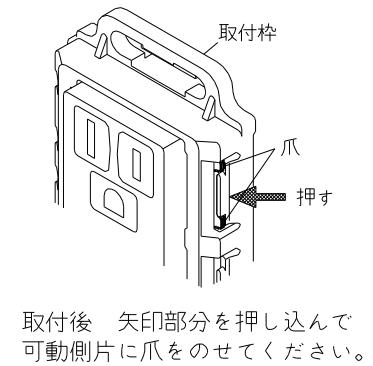
取付後 矢印部分を押し込んで可動側片に爪をのせてください。
