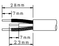
適合する圧着端子をかしめてネジ止めしてください。
